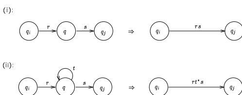
2. Tiivistyksen päätyessä jäljellä olevaa 2-tilaista automaattia vastaava säännöllinen lauseke muodostetaan seuraavan kuvan esittämällä tavalla:
